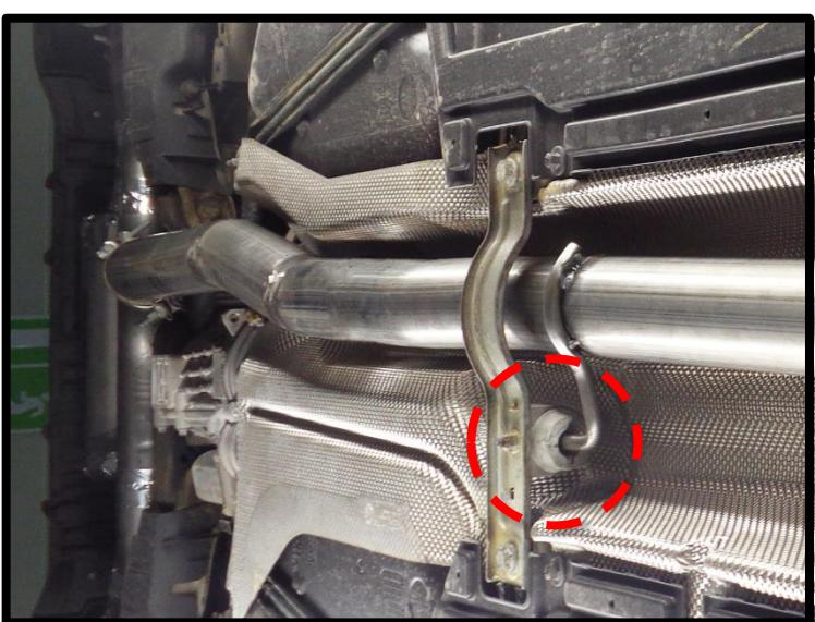
Den REMUS Sportschalldämpfer am Racing Rohr montieren und die Gummiaufhängungen an den Befestigungspunkten der Karosserie einhängen. Die REMUS Auslassbögen am Sportschalldämpfer montieren. Den Aktuator anschließen.
