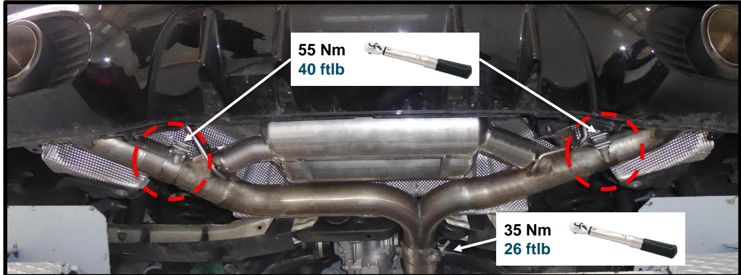
Die REMUS Endrohrblenden am Fahrzeug montieren
