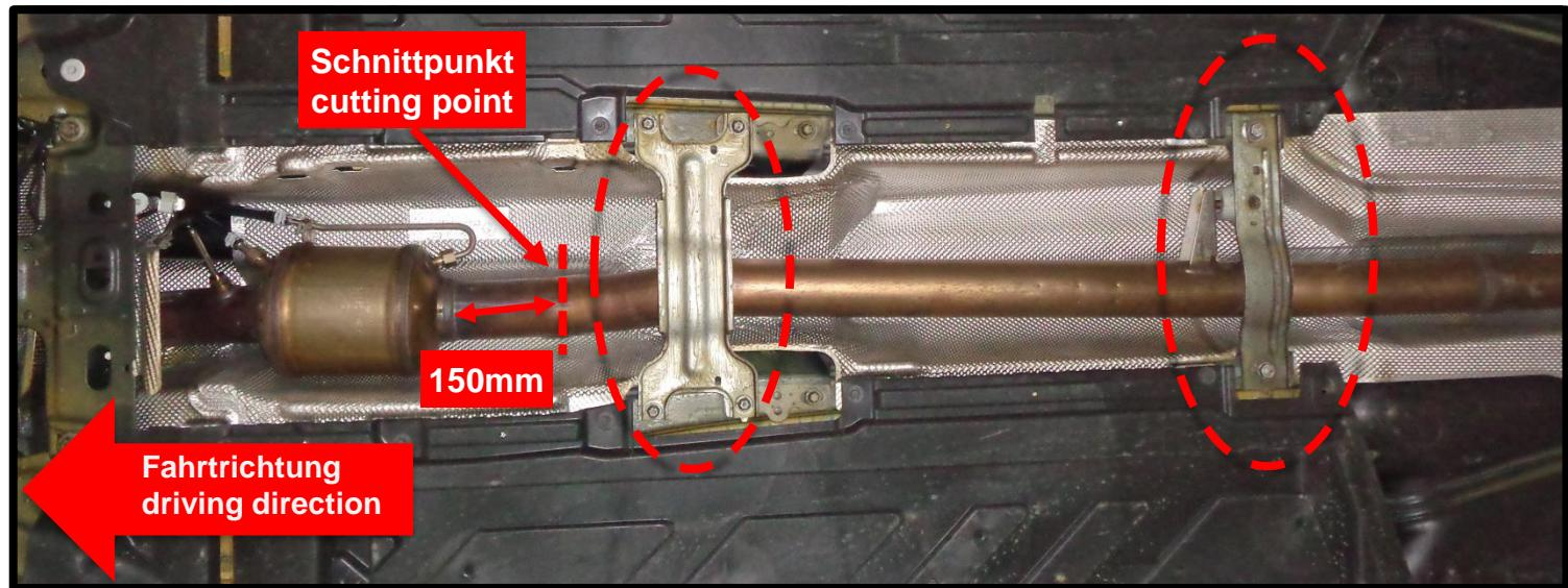
Die Aufhängungsgummis aushängen, den Aktuator abschließen und die serienmäßige Abgasanlage abnehmen.
