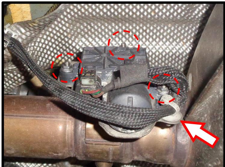
Das REMUS Racing Rohr auf das Serienrohr aufschieben und die Gummiaufhängungen an den Befestigungspunkten der Karosserie einhängen. Die Querstreben wieder montieren.
